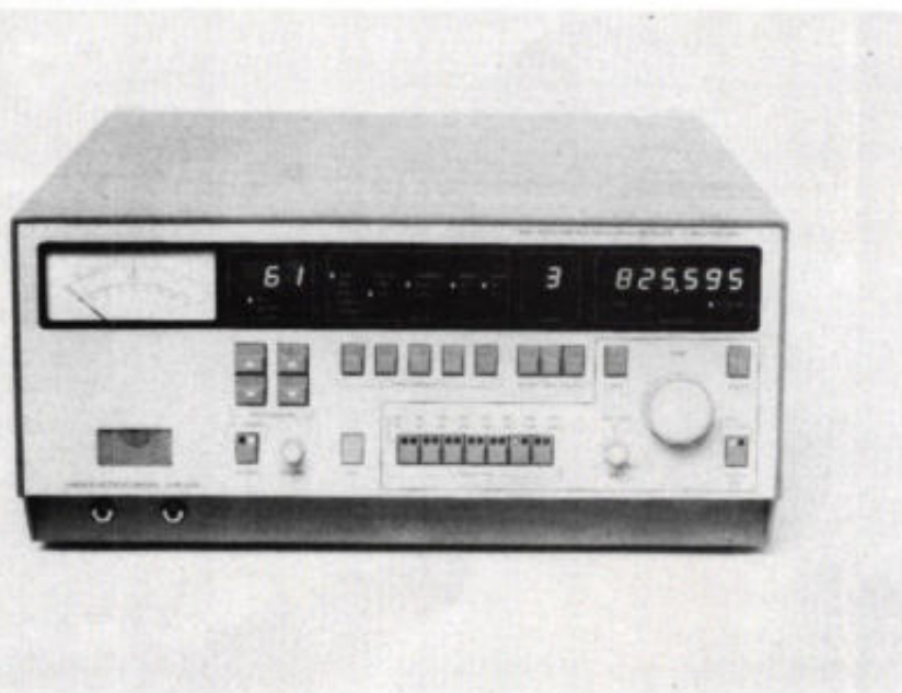
EMI-meetontvanger met preselector (Chase Electronics) voor een frequentiegebied van 25 MHz ... 1000 MHz.
